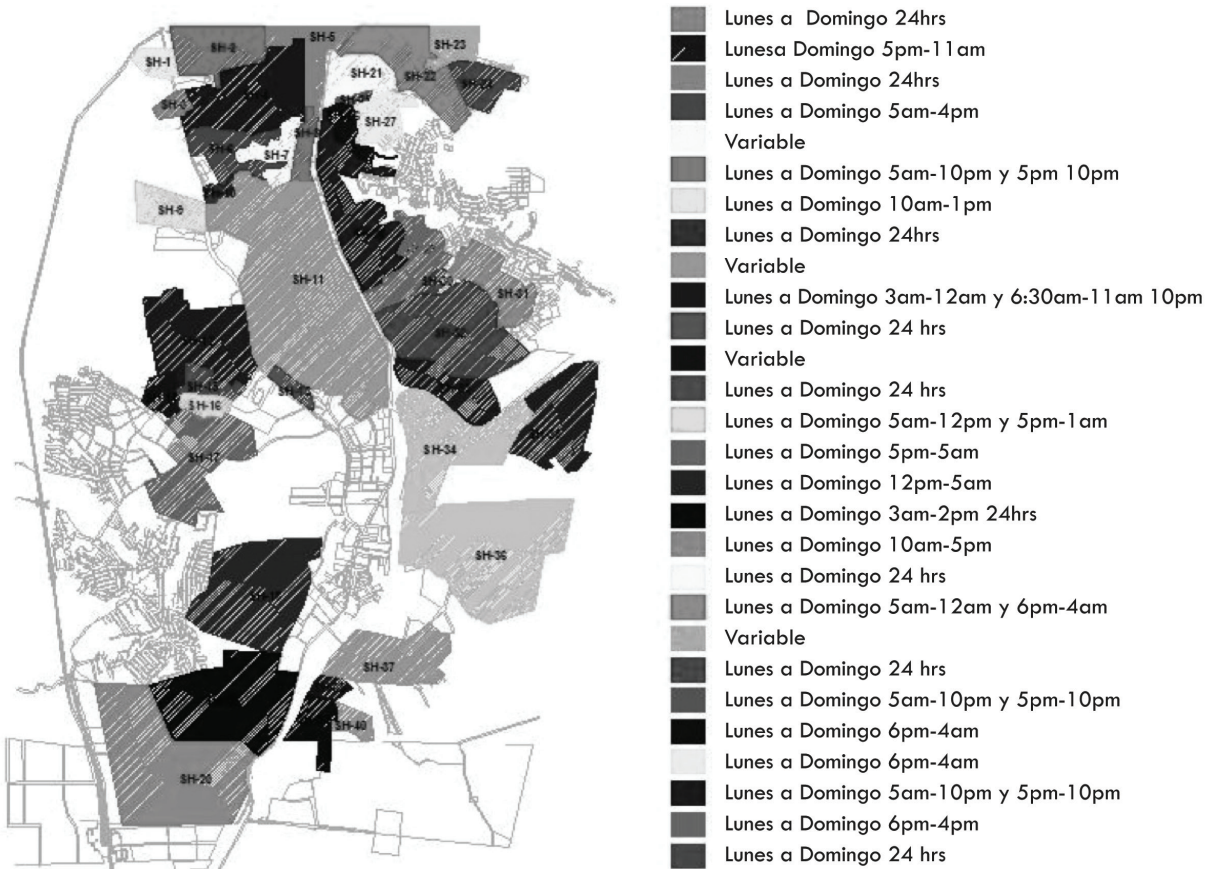
Figure 2-4. The schedule for tandeo , or staggered water service, in Nogales, Son. The legend at right shows variable hours of service across the city, from 3-hours to 6- and 12-hours to 24 hours. Source: OOMAPAS 2008, courtesy of Arturo Pedraza Martínez, 2008. Proyecto de eficiencia física, operación hidráulica y electromecánica, para la ciudad de Nogales, Son. (Watergy 2008).
